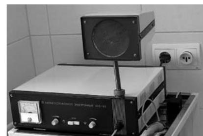
Рис. 2.1а. Электронный ларингостробоскоп
