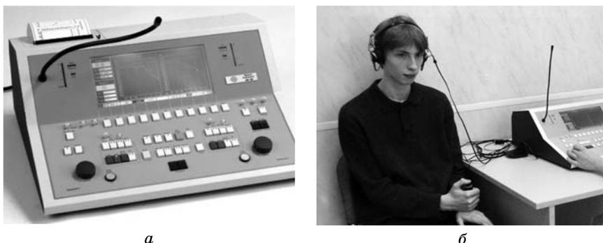
Рис. 2.7. Клинический аудиометр АС-40, Interacoustics: а — общий вид; б — момент проведения исследования
